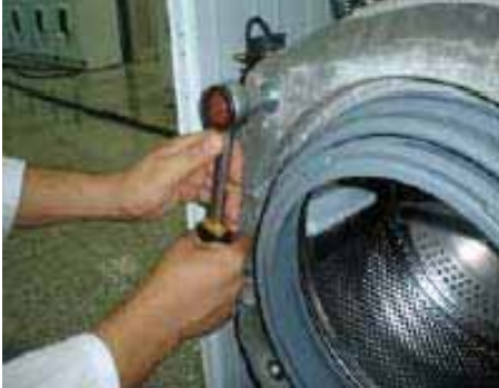
Démonter les axes des amortisseurs
